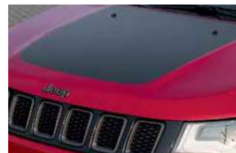
Спецподготовка Трейлхока заключается в установке сношенного переднего бампера с 30-градусным углом въезда и внедорожных колес, увеличивающих клиренс до 216 мм. Антибликовый сектор на капоте и алые буксирные крюки — боевая индейская раскраска.
